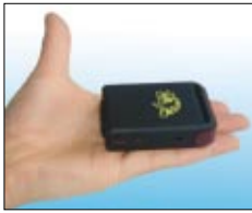
◀ Der kompakte GPS Tracker TK102 sendet auf Anforderung Positionsangaben
